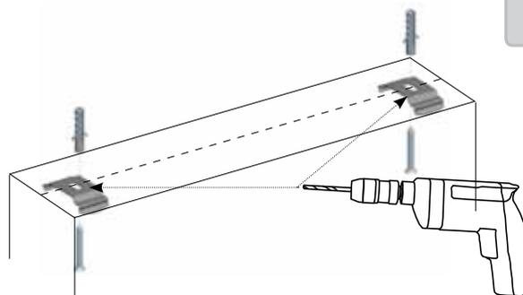
Percer le mur au diamètre 6mm au-dessus de la moustiquaire. Placer les clips et serrer avec les vis fournies.
