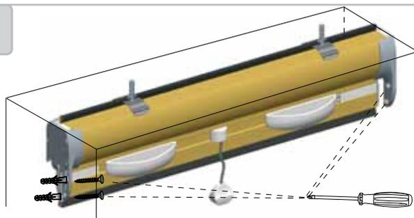
Accrocher le boîtier aux clips; pour la fixation latérale, marquer avec un crayon les points où percer, détacher le boîtier, percer au diamètre de 6mm et raccrocher et bloquer le boîtier avec les vis données
